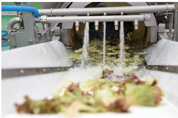
連続式異物除去洗浄装置「スパイラル」を導入。ドラム式を採用し、水槽の中で回転しながら水圧により虫や野菜の屑を完全除去します。
